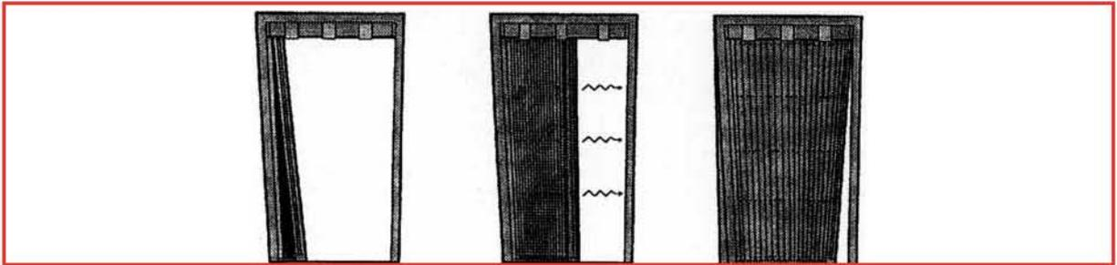
Puede ser que el **poste móvil** que regula la apertura de la tela esté **desajustado**, para solucionar esto deberá ajustar el poste móvil.
